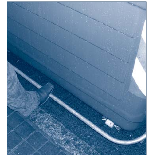
Al pisar el pedal de los nuevos contenedores se levanta la tapa.
